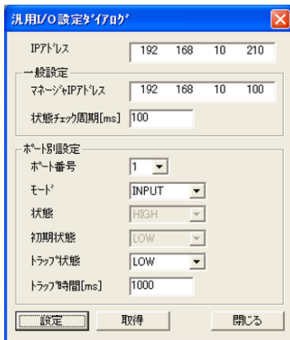
図 6.5. 汎用 I/O の設定例
