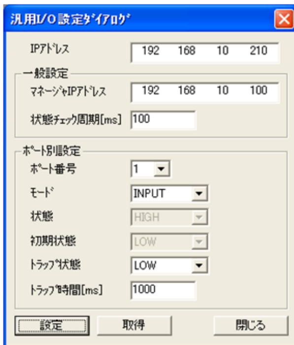
図 6.5. 汎用 I/O の設定例
