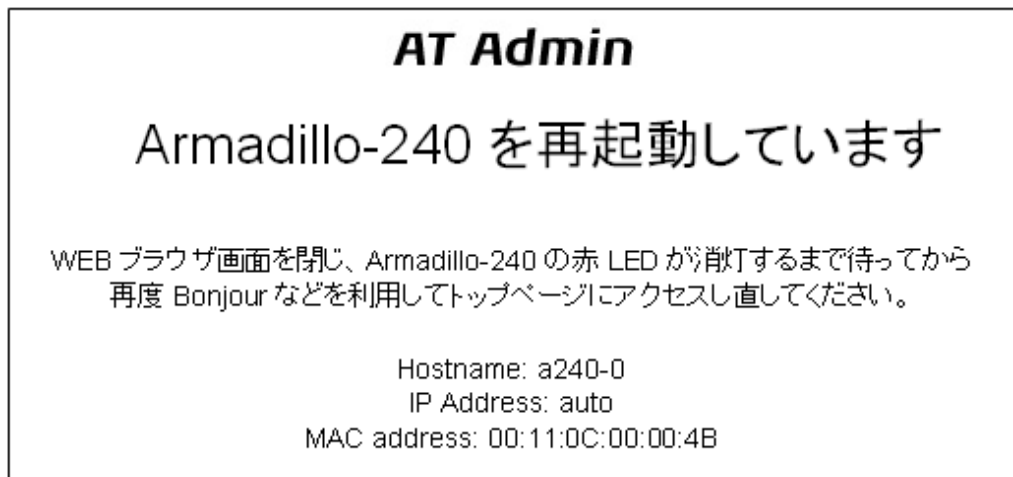
図 5.12. AT Admin: System - Reboot
