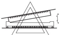
図 9.13 コネクタ抜去時の取扱い上の注意 2
