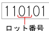
図 2.13 Armadillo-400 シリーズ LCD 拡張ボードのロットシールフォーマット
