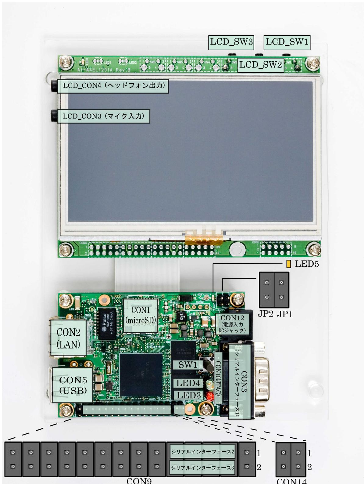
図 2.3 Armadillo-440 液晶モデル見取り図
