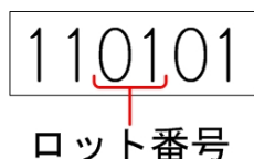
図 1.12 Armadillo-400 シリーズ LCD 拡張ボードのロットシールフォーマット
