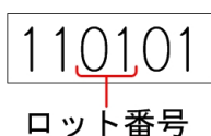
図 2.21 Armadillo-400 シリーズ WLAN インターフェースボード(AWL13 対応)のロットシールフォーマット
