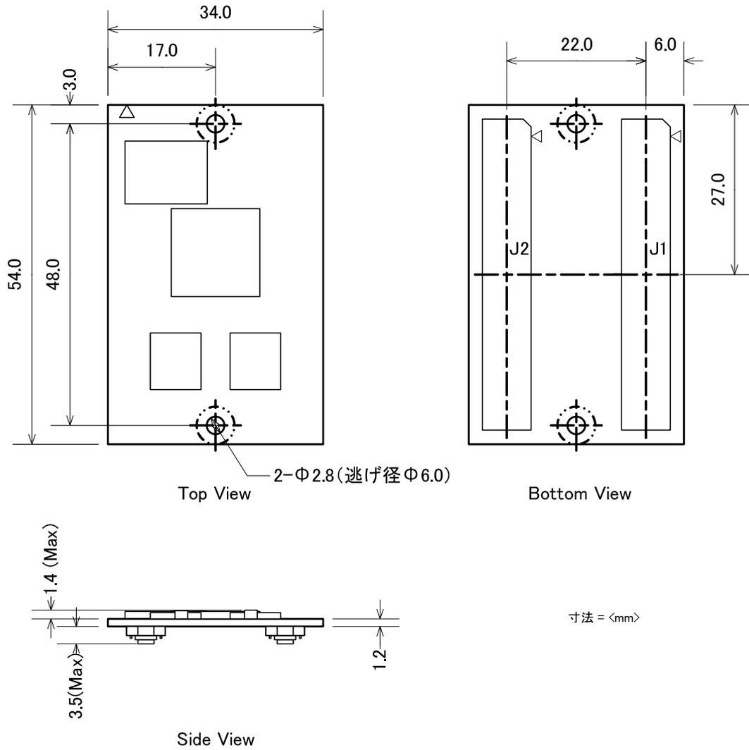
図 6.2. Armadillo-500 CPU モジュールの基板形状
