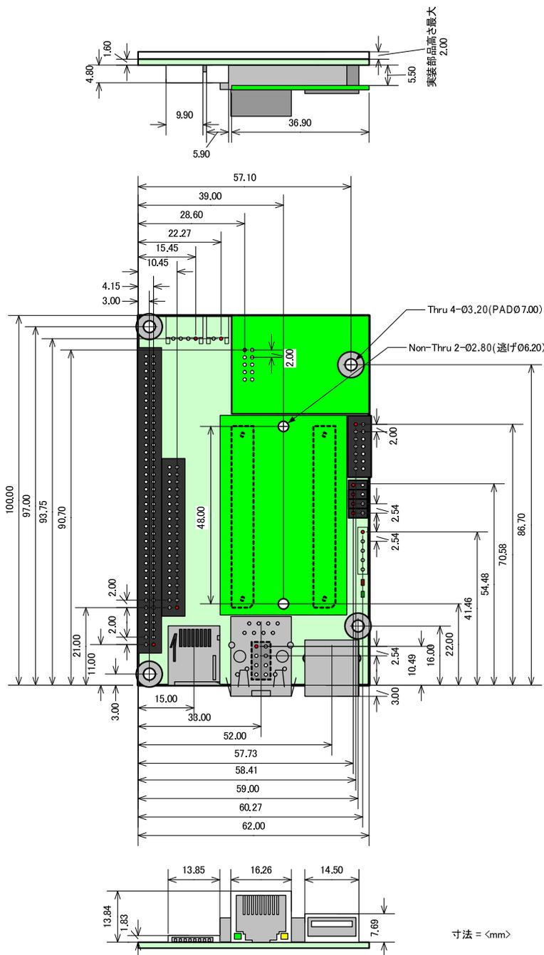
図 6.1. Armadillo-500 FX の基板形状
