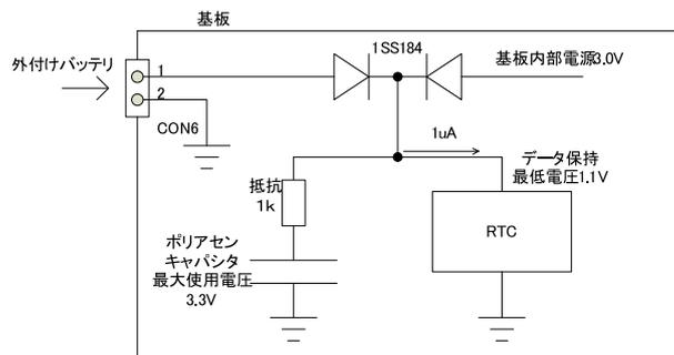
図 5.2. 外付けバッテリーの接続
