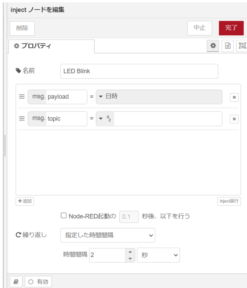
図 4.4 [inject] ノードのプロパティ内容
