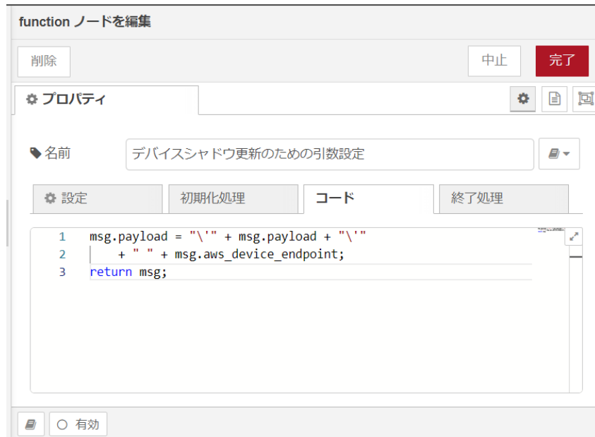
図 4.66 [デバイスシャドウ更新のための引数設定] ノードのプロパティ内容
