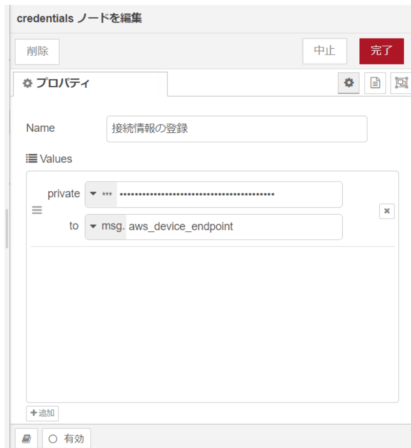
図 4.61 [接続情報の登録] ノードのプロパティ内容
