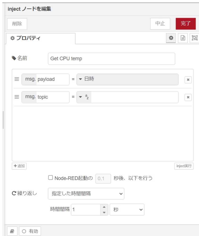
図 4.8 [inject] ノードのプロパティ内容
