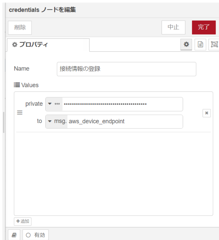
図 4.67 [接続情報の登録] ノードのプロパティ内容
