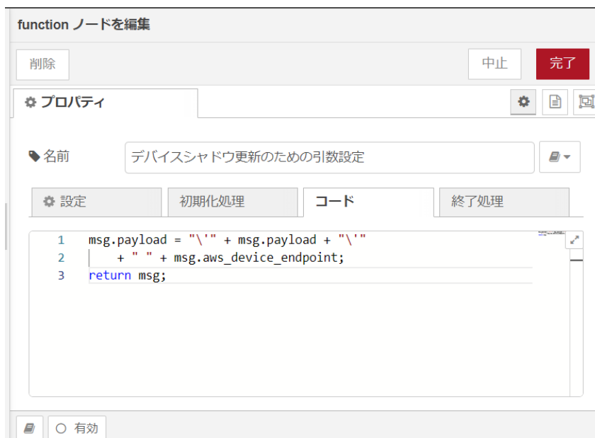
図 4.68 [デバイスシャドウ更新のための引数設定] ノードのプロパティ内容
