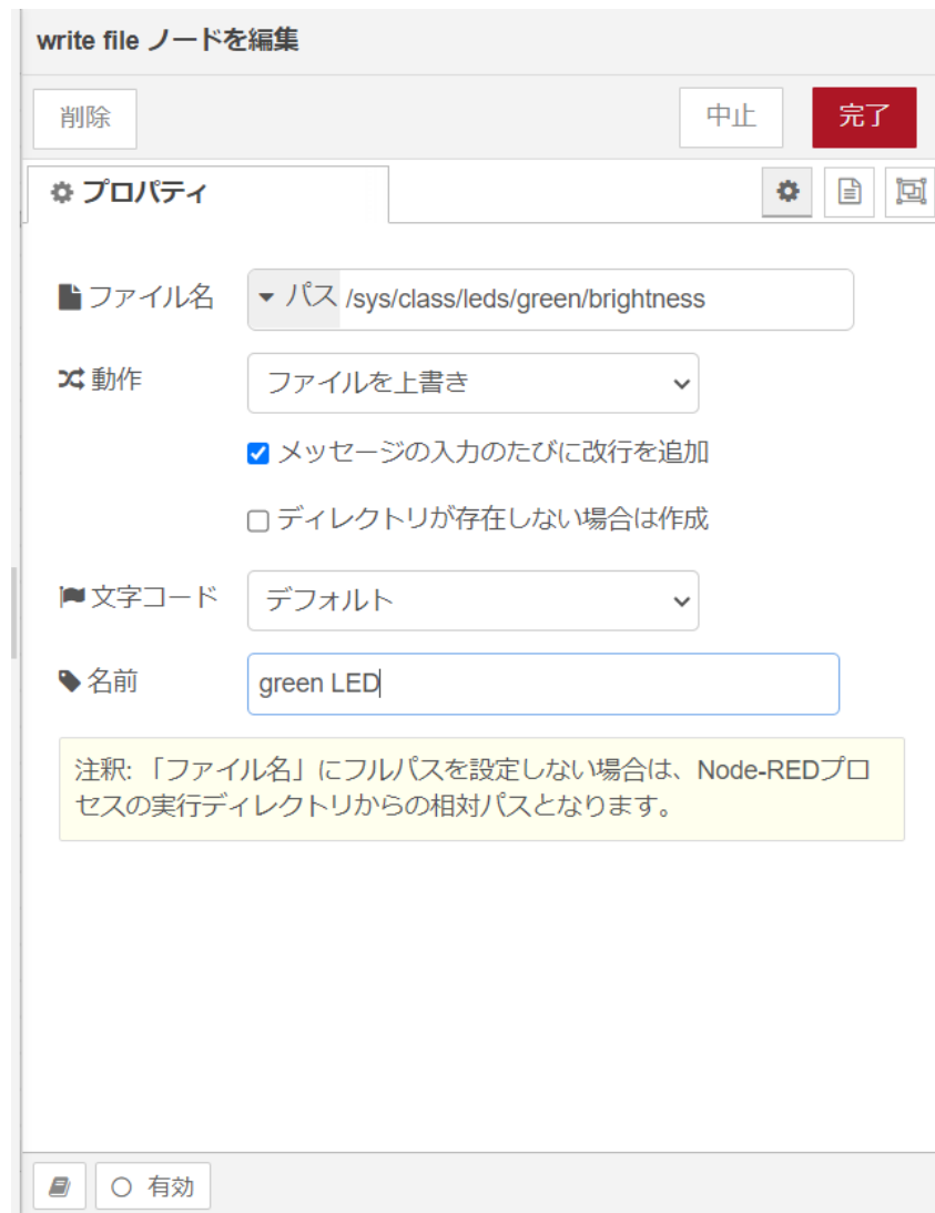
図 4.6 [write file] ノードのプロパティ内容
