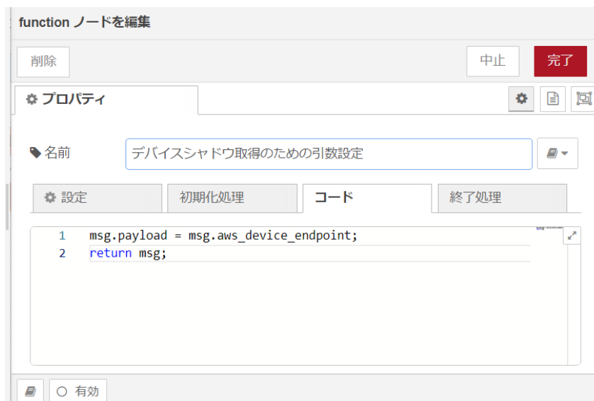
図 4.62 [デバイスシャドウ取得のための引数設定] ノードのプロパティ内容
