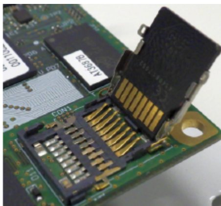
図 16.4 microSD カードの挿抜
