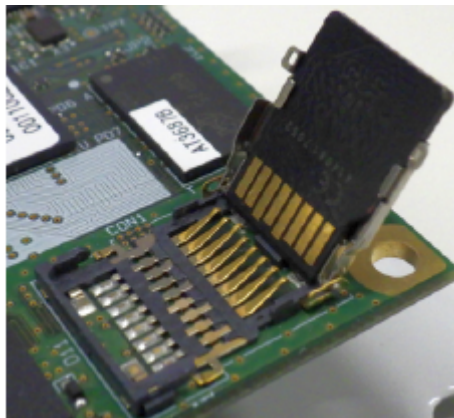
図 16.4 microSD カードの挿抜
