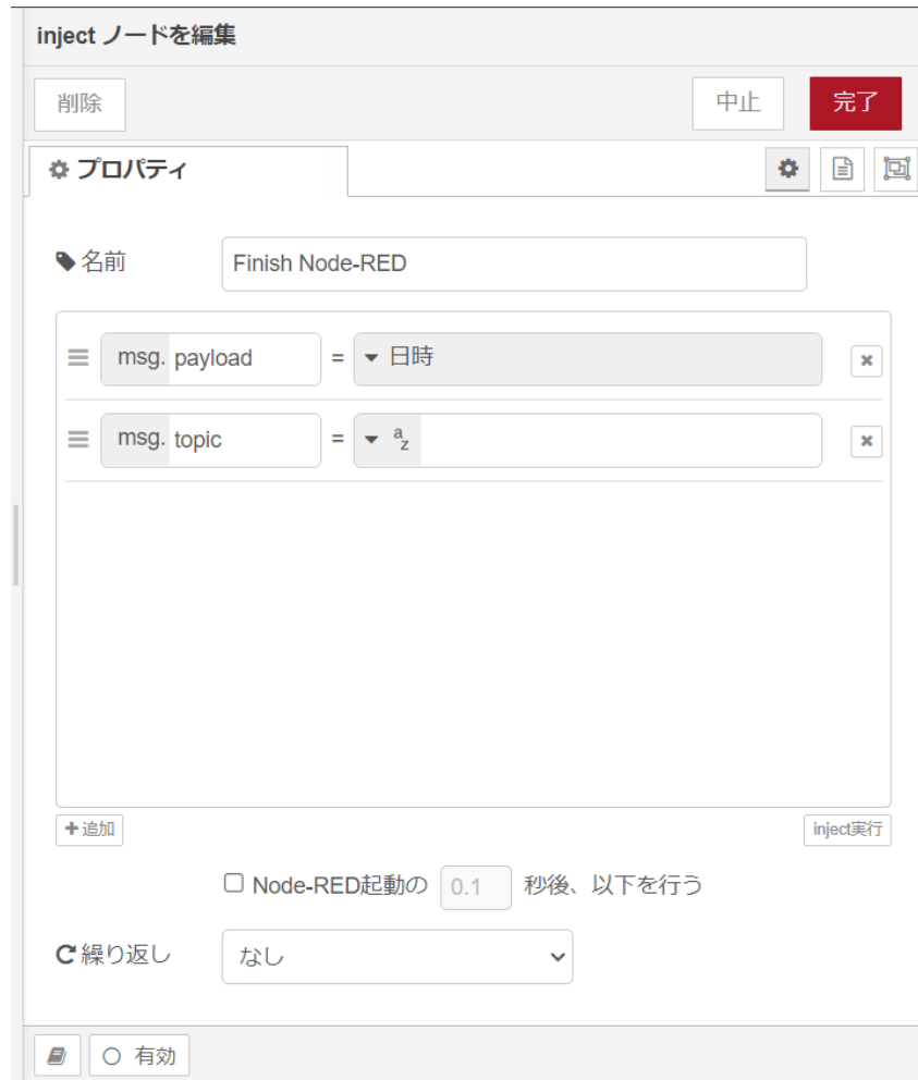
図 4.27 [inject] ノードのプロパティ内容
