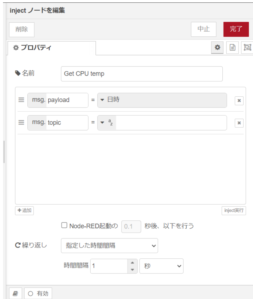
図 4.7 [inject] ノードのプロパティ内容
