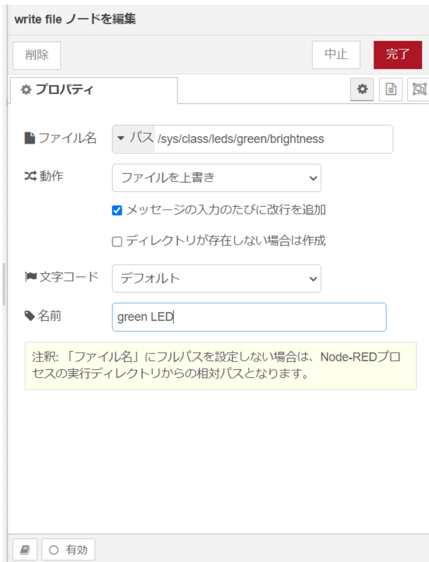
図 4.5 [write file] ノードのプロパティ内容
