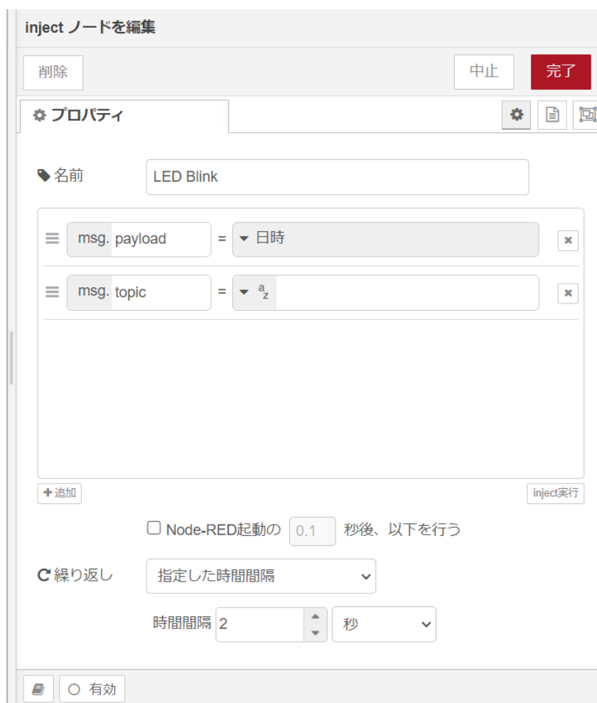
図 4.3 [inject] ノードのプロパティ内容
