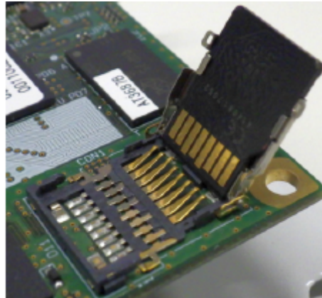
図 5.18 microSD カードの挿抜
