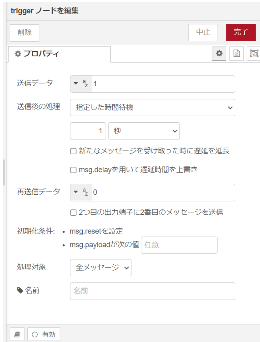
図 4.4 [trigger] ノードのプロパティ内容
