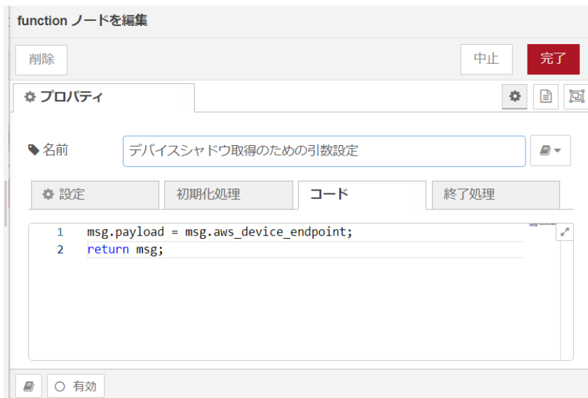
図 4.61 [デバイスシャドウ取得のための引数設定] ノードのプロパティ内容
