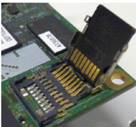
図 16.4 microSD カードの挿抜
