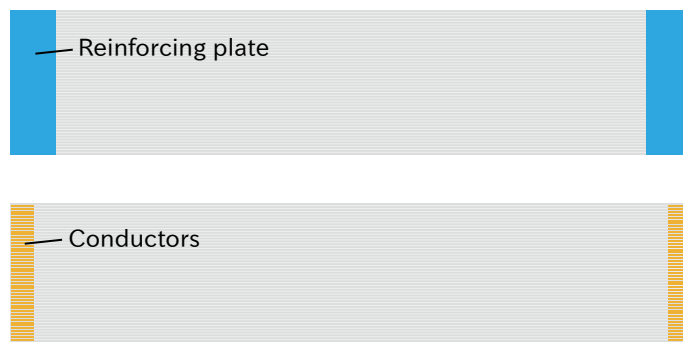
図 18.9 フレキシブルフラットケーブルの形状
