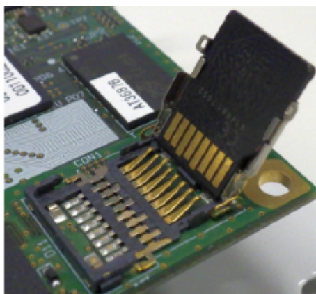
図 16.4 microSD カードの挿抜
