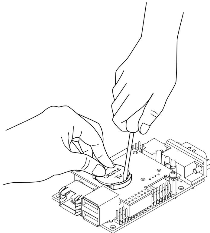
図 18.25 電池ホルダから電池を取り外す
