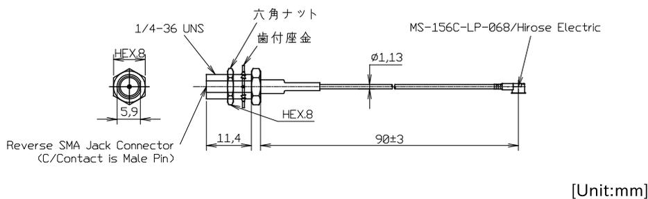
図 18.49 アンテナケーブルの形状図
