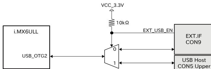
図 16.8 USB OTG2 の接続先の変更
