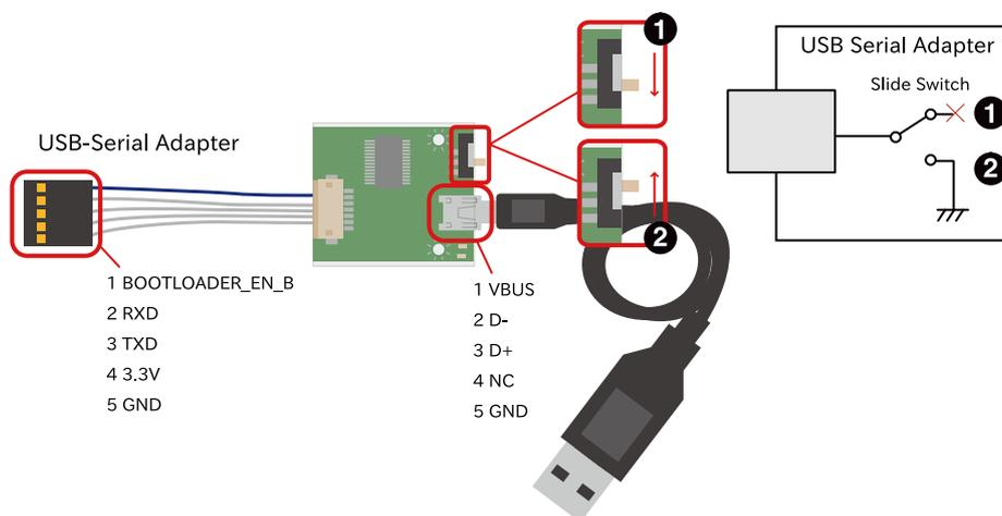
図 18.1 USB シリアル変換アダプタの配線
