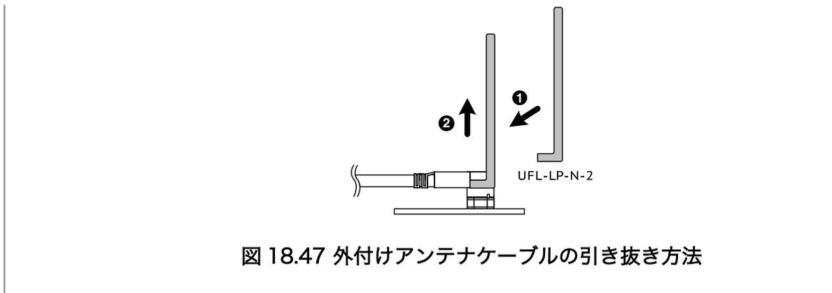
図 18.47 外付けアンテナケーブルの引き抜き方法
