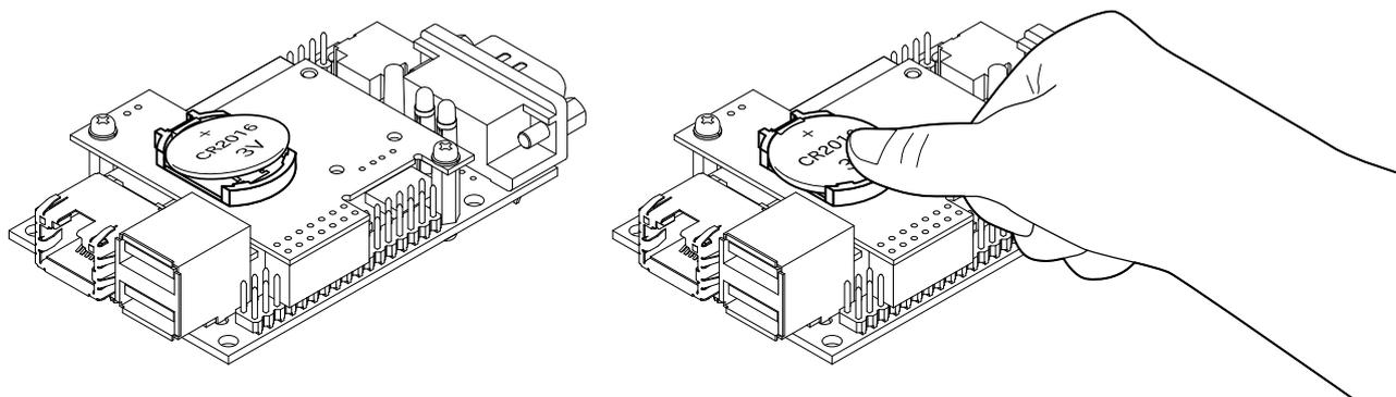
図 18.14 電池ホルダに電池を取り付ける
