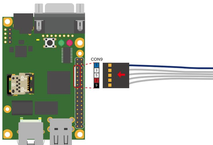
図 4.13 CON9-USB シリアル変換アダプタ接続図
