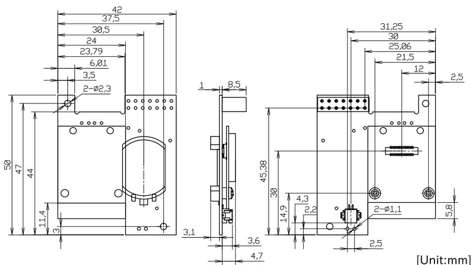
図 18.26 WLAN オプションモジュール形状
