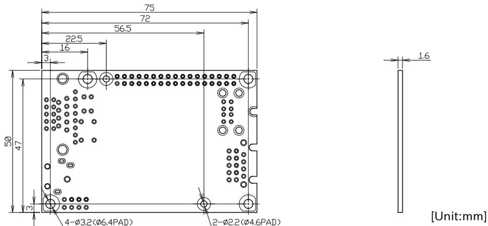
図 17.1 基板形状および固定穴寸法
