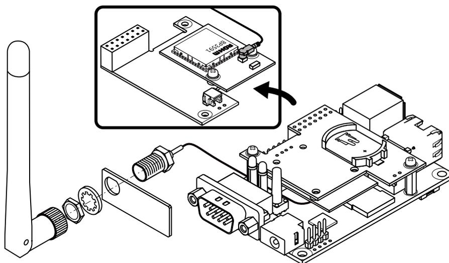
図 18.46 外付けアンテナの取り付け
