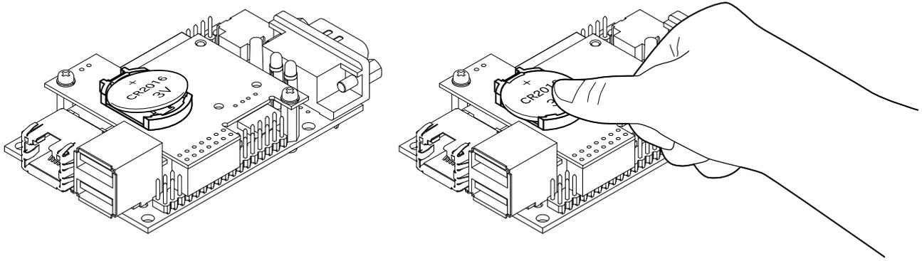
図 18.24 電池ホルダに電池を取り付ける
