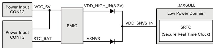
図 16.12 バックアップ電源供給
