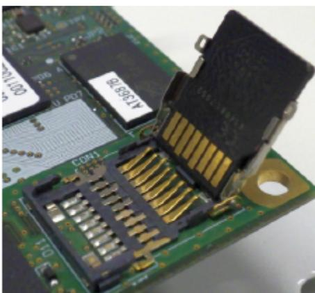
図 16.4 microSD カードの挿抜
