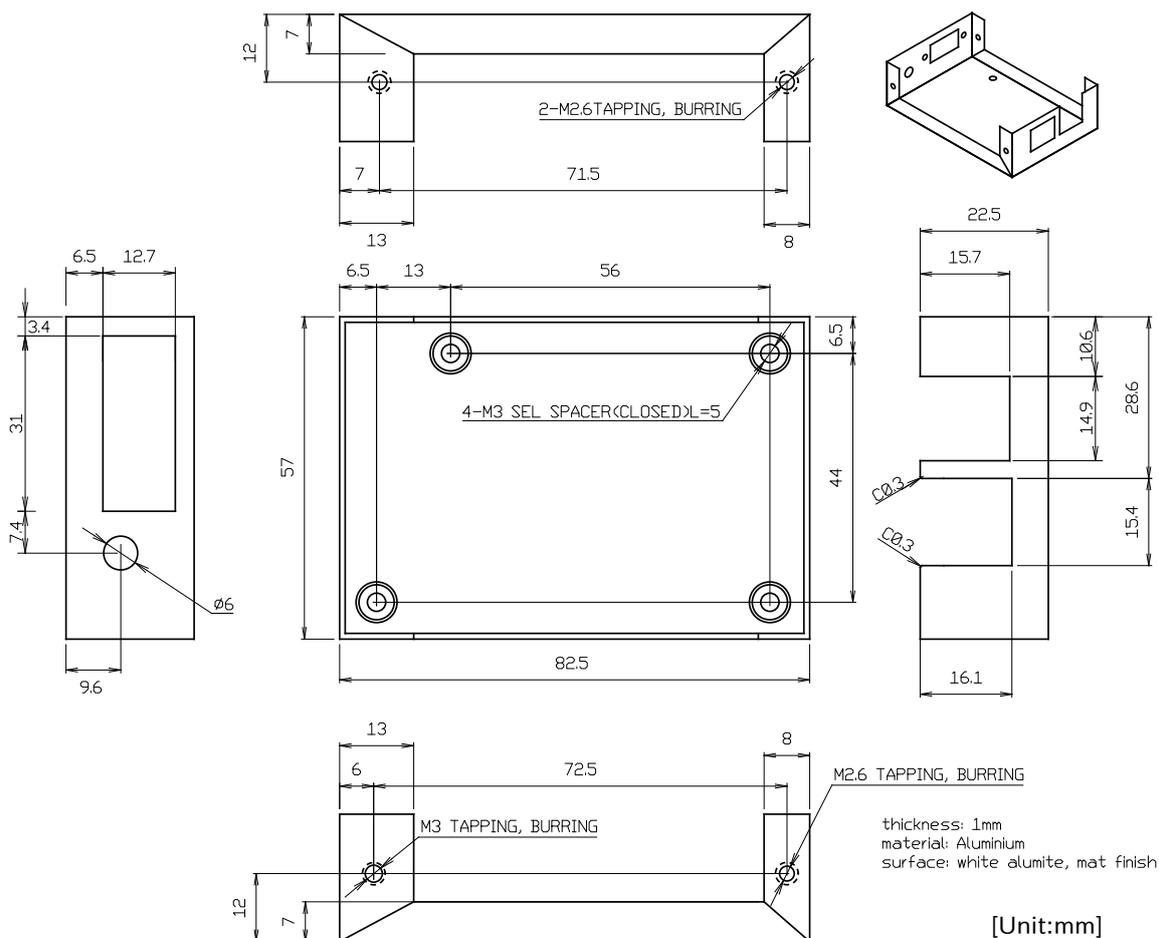
図 18.7 金属ケース(下板)寸法図
