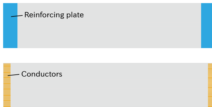
図 3.90 フレキシブルフラットケーブルの形状
