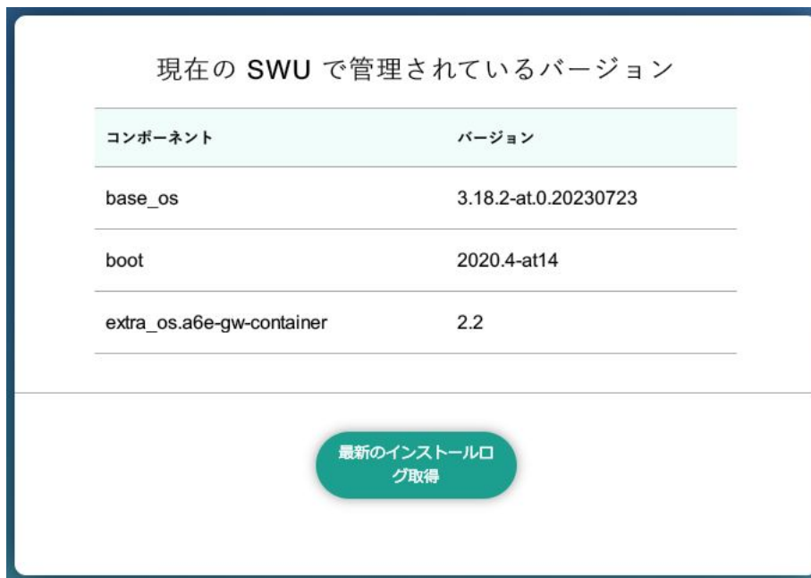
図 6.90 SWU 管理対象ソフトウェアコンポーネントの一覧表示
