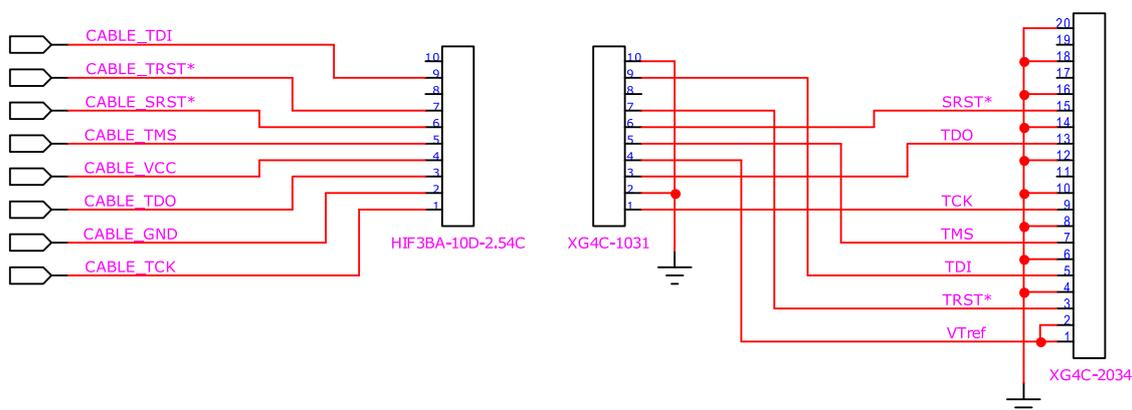
図 20.24 8 ピン JTAG 変換ケーブルの参考回路
