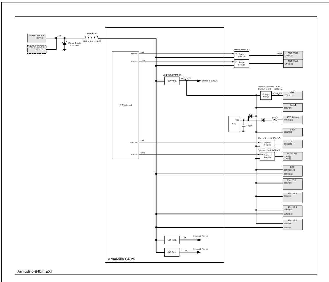
図 18.5 Armadillo-840m 電源回路の構成
