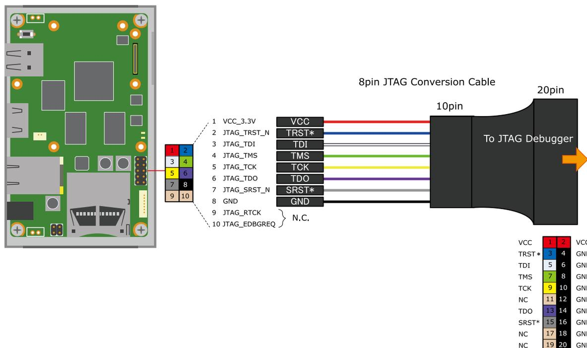
図 20.23 8 ピン JTAG 変換ケーブルの接続図
