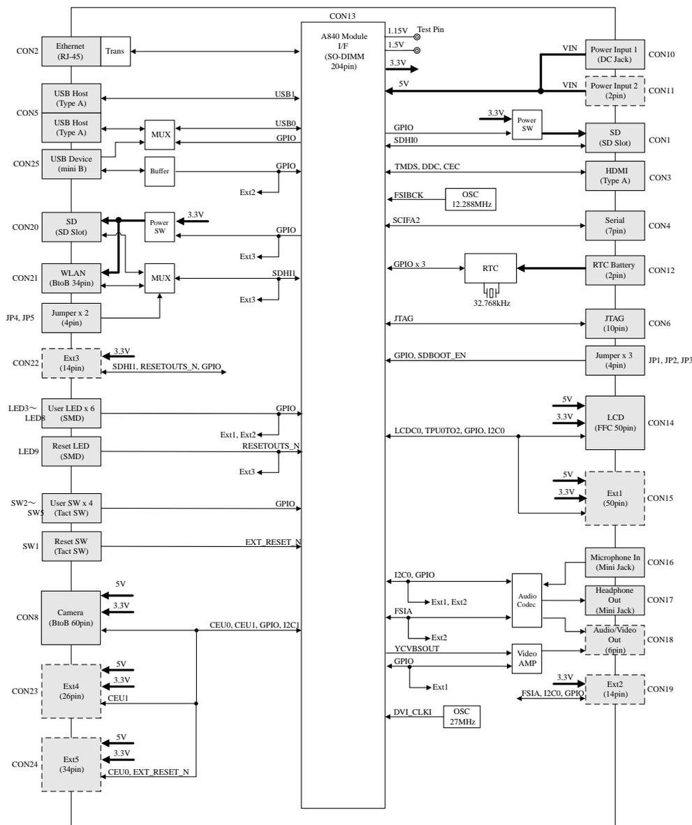
図 20.36 Armadillo-840m ベーシックモデル開発セット拡張基板のブロック図
