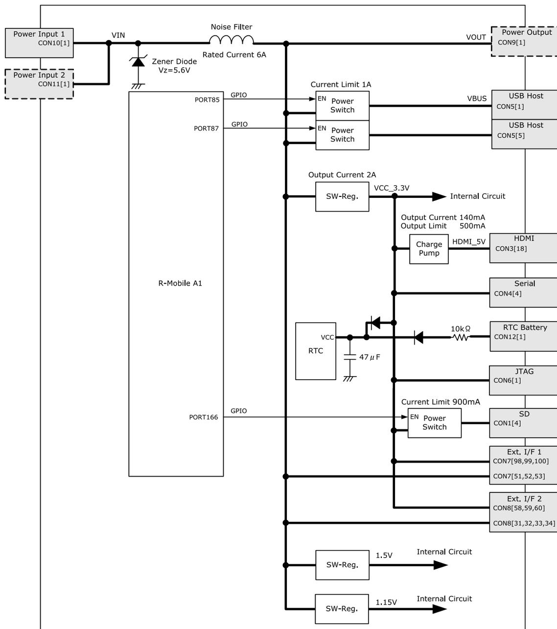
図 18.4 Armadillo-840 電源回路の構成
