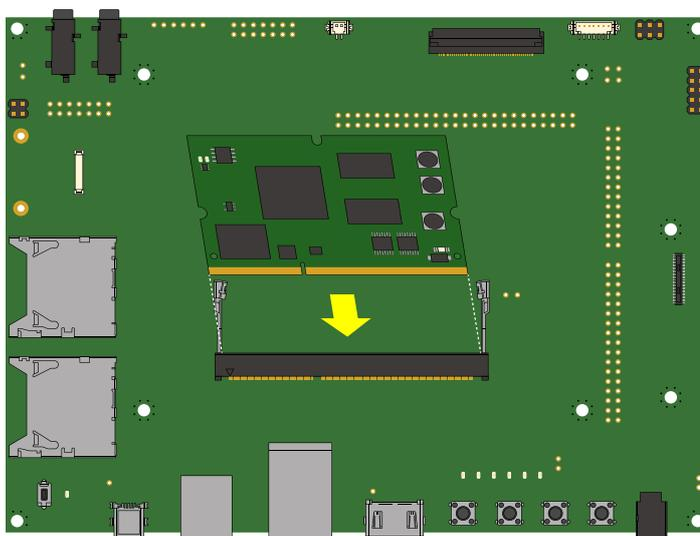
図 20.44 Armadillo-840m を SO-DIMM コネクタに差し込む
