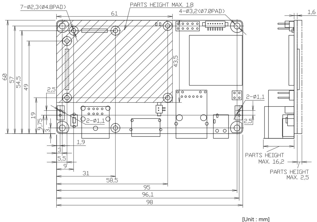
図 19.1 Armadillo-840 基板形状および固定穴寸法
