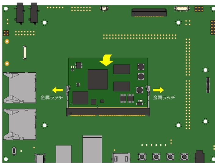
図 20.46 SO-DIMM コネクタの金属ラッチをゆっくりと広げる
