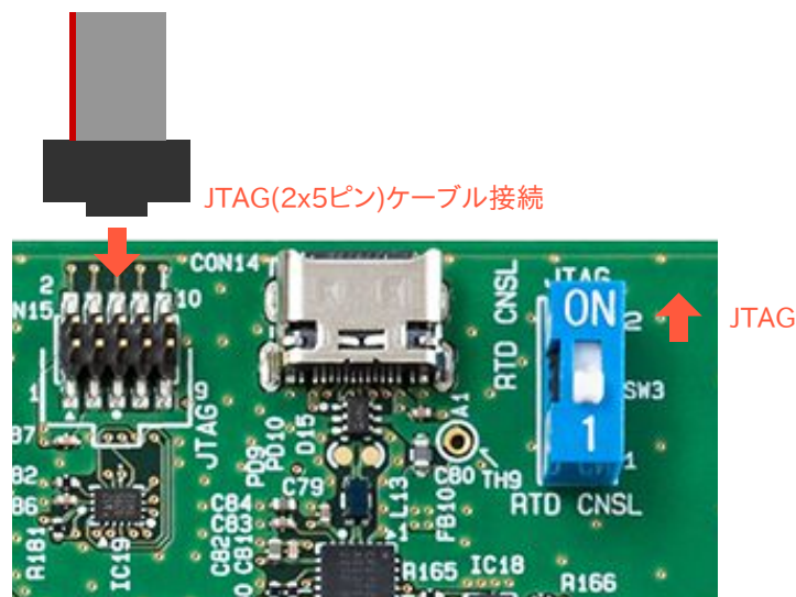
図 5.123 JTAG ケーブル接続/切替スイッチ制御
