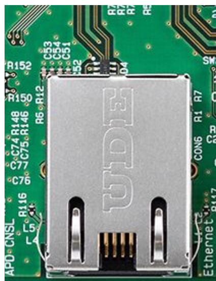
Ethernetケーブル接続
