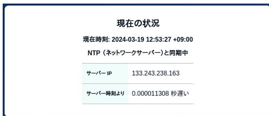
図 10.59 ネットワークタイムサーバーと同期されている場合の状況確認画面
