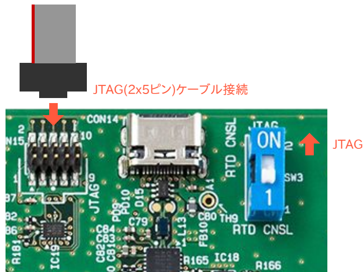
図 5.125 JTAG ケーブル接続/切替スイッチ制御
