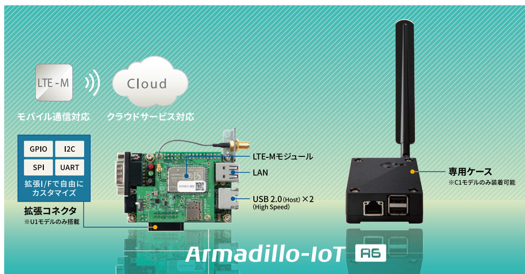
図 3.1 Armadillo-IoT ゲートウェイ A6 とは
