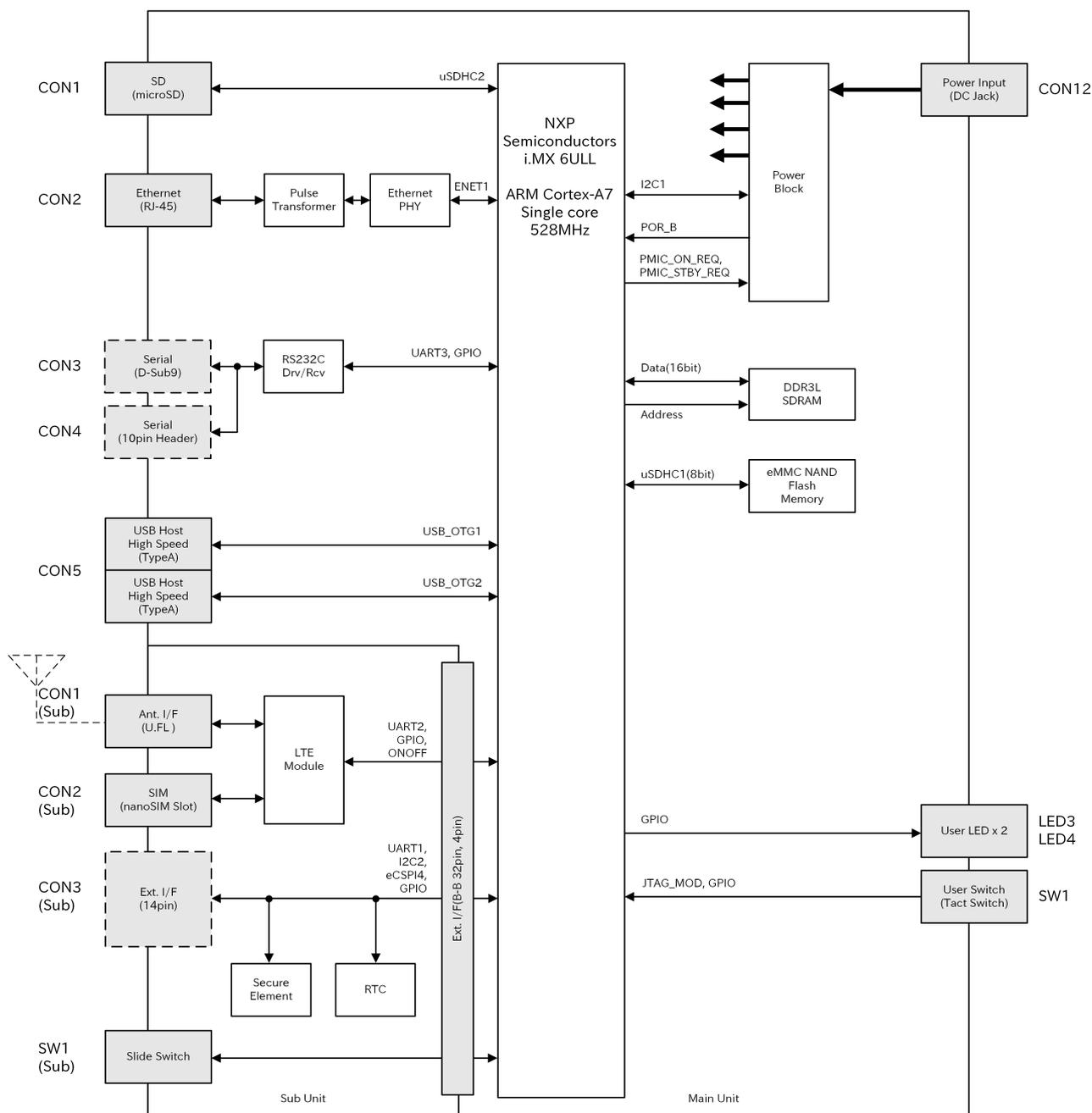
図 3.6 Armadillo-IoT ゲートウェイ A6 ブロック図
