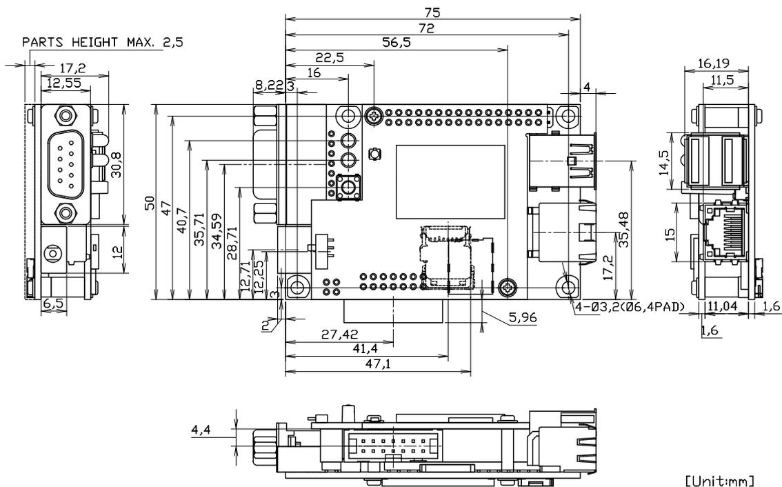
図 19.2 基板寸法図
