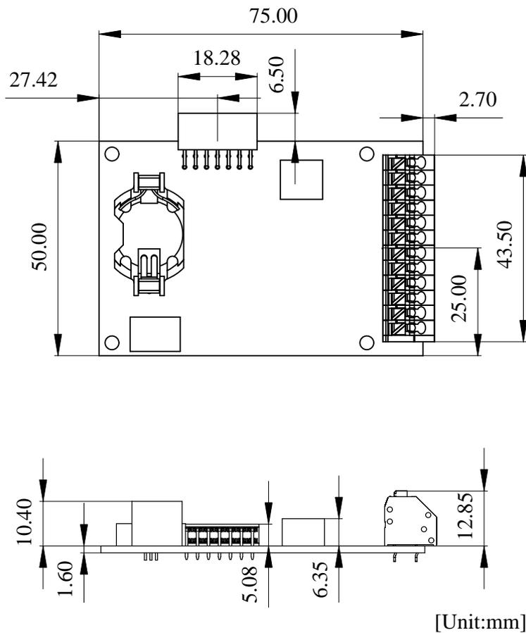
図 20.12 基板形状およびコネクタ中心寸法
