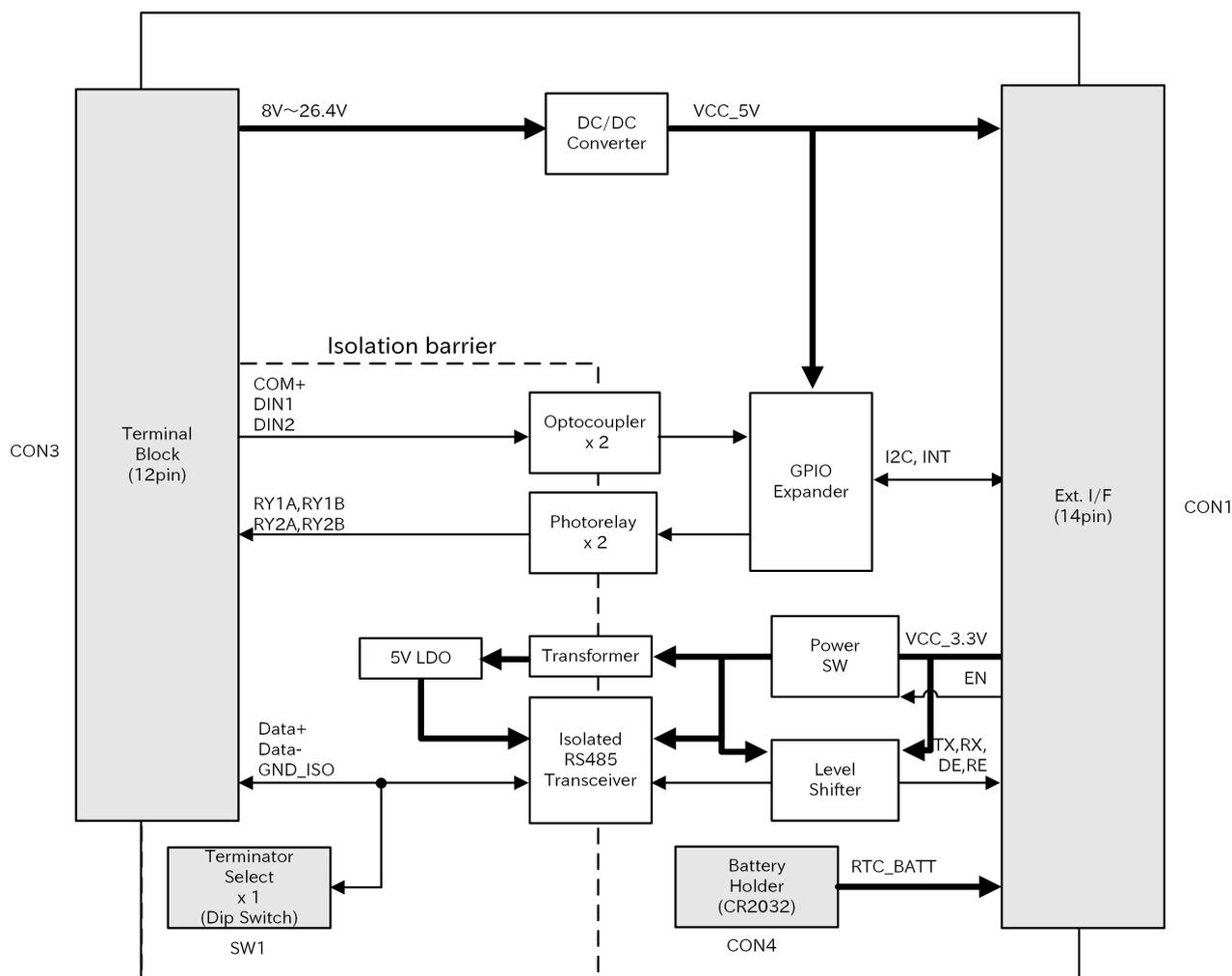
図 20.5 Armadillo-IoT ゲートウェイ A6 U1 モデル用 拡張 I/O ボード 01 ブロック図
