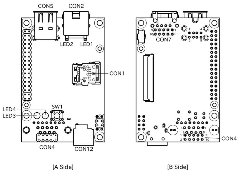
図 4.15 メインユニットインターフェースレイアウト(C1 モデル)
