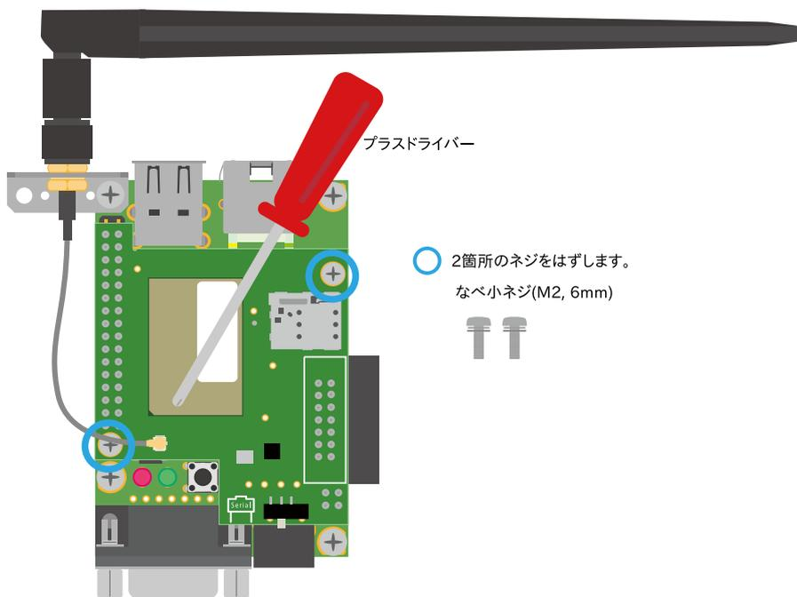
図 4.1 サブユニット固定ネジの取り外し
