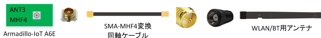
図 15.25 ANT3 RP-SMA 端子のアンテナ接続例
