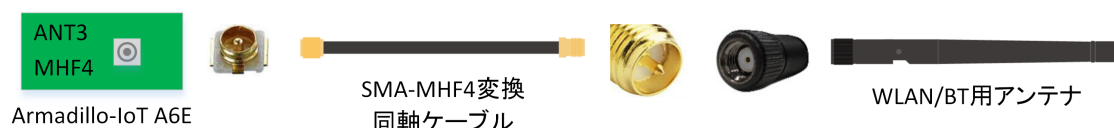
図 3.45 ANT3 RP-SMA 端子のアンテナ接続例
