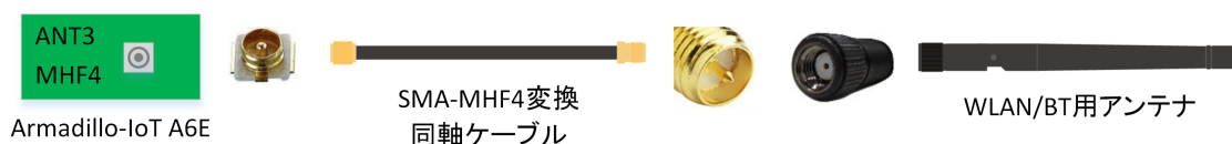
図 3.45 ANT3 RP-SMA 端子のアンテナ接続例
