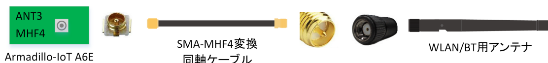
図 3.45 ANT3 RP-SMA 端子のアンテナ接続例
