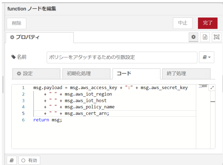
図 4.75 [ポリシーをアタッチするための引数設定] ノードのプロパティ内容
