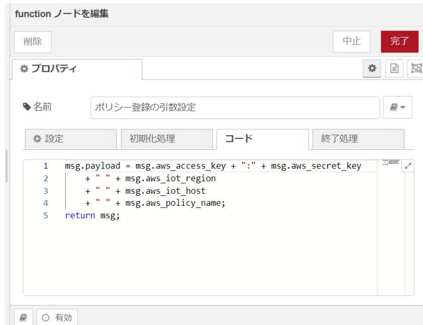
図 4.64 [ポリシー登録の引数設定] ノードのプロパティ内容
