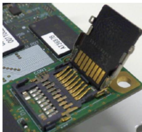
図 14.6 microSD カードの挿抜
