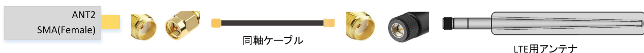
図 14.17 ANT2 50Ω 同軸ケーブルでの延長例(LTE アンテナインターフェース)
