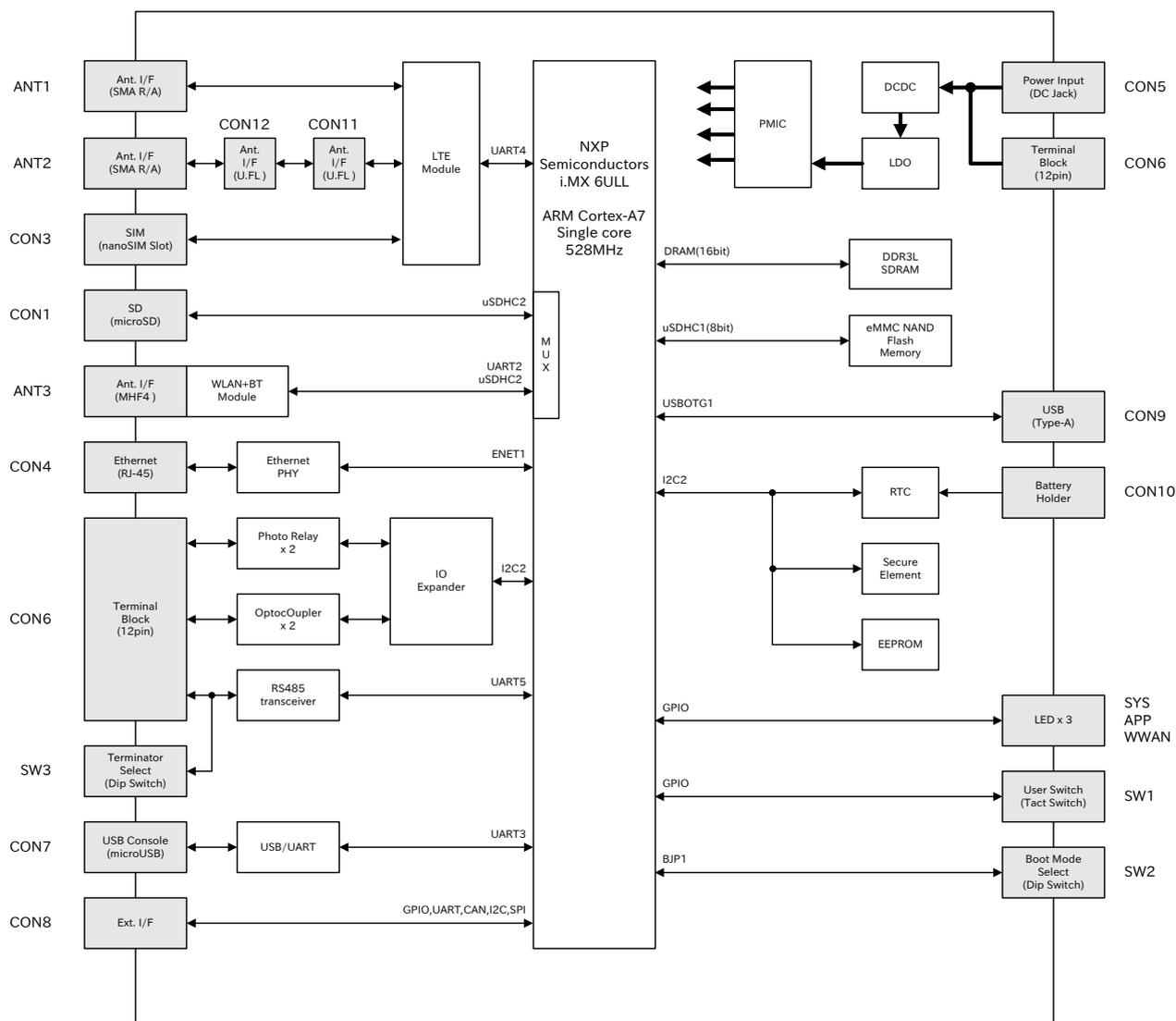
図 3.10 Armadillo-IoT ゲートウェイ A6E ブロック図
