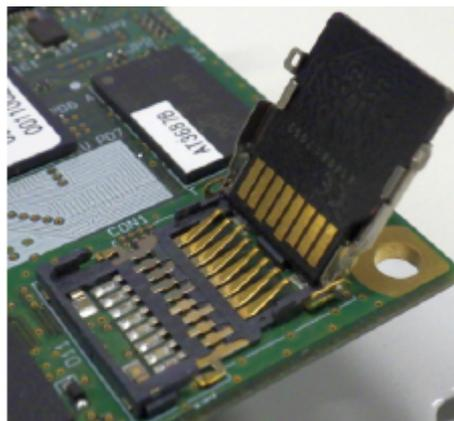
図 14.6 microSD カードの挿抜
