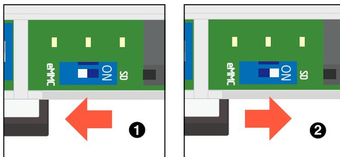
図 14.21 スイッチの状態と起動デバイス
