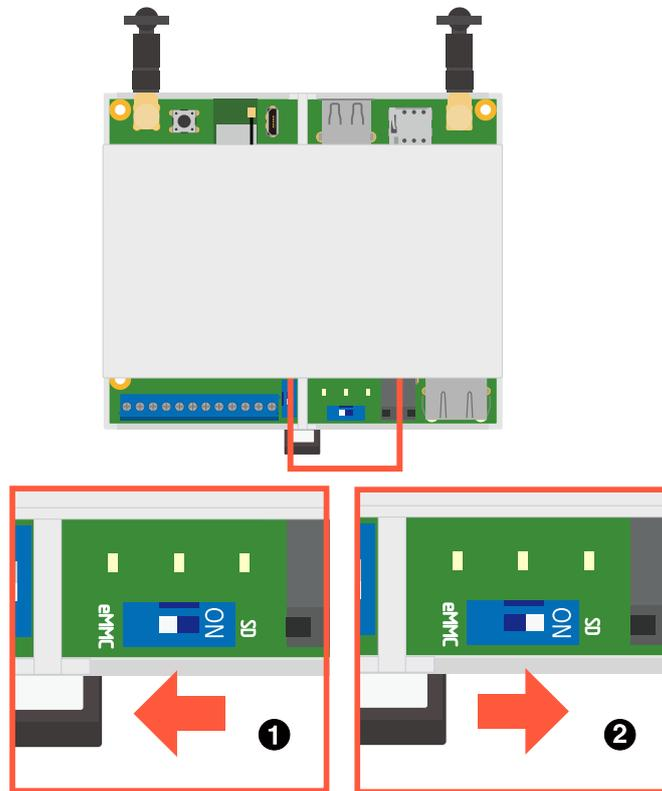
図 4.13 起動デバイス設定スイッチの操作
