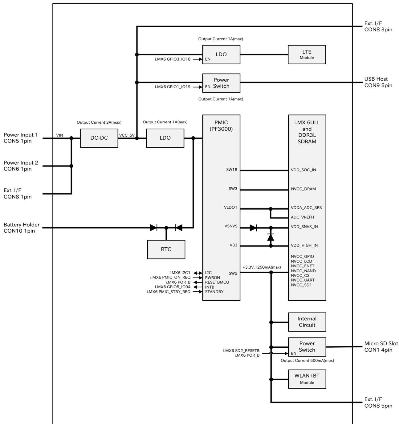
入力電圧(VIN)を電源 IC で各電圧に変換し、内部回路および各インターフェースに供給しています。各インターフェースやスイッチング・レギュレータの最大出力電流値を超えないように、外部機器の接続、供給電源の設計を行なってください。
