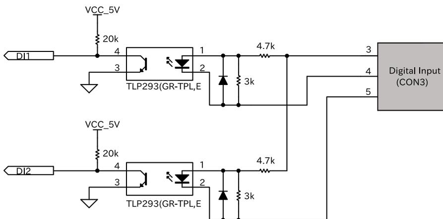
図 14.12 CON6 接点入力周辺回路
