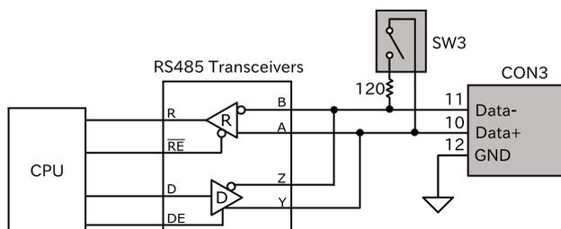
図 14.14 CON6 RS485 トランシーバ周辺回路
