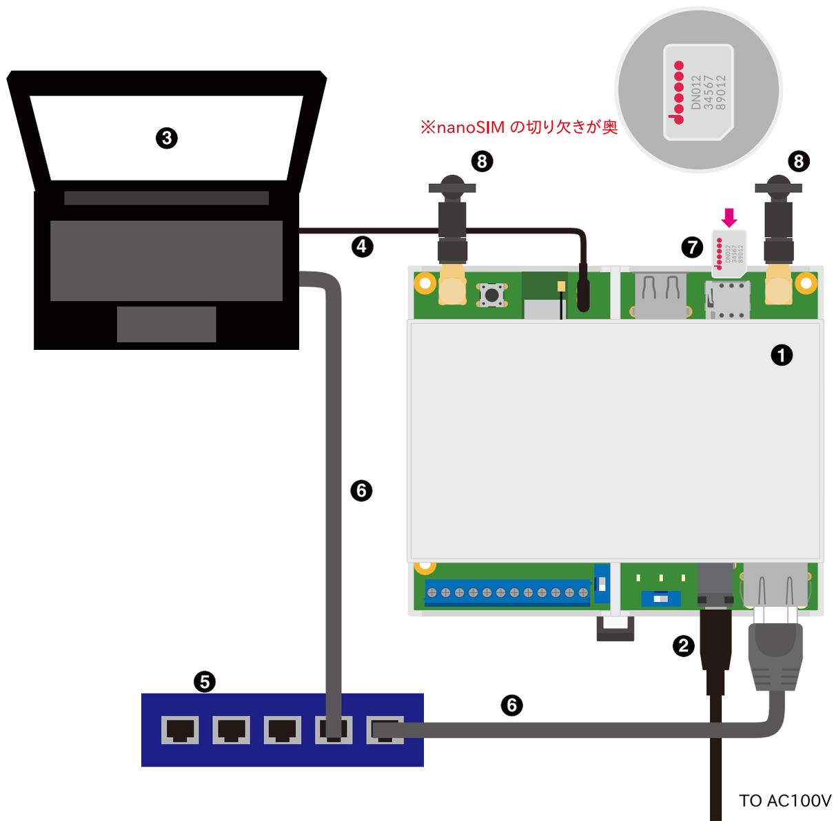
図 4.12 Armadillo-IoT ゲートウェイ A6E の接続例
