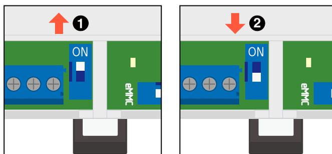
図 14.22 スイッチの状態と終端抵抗の ON/OFF
