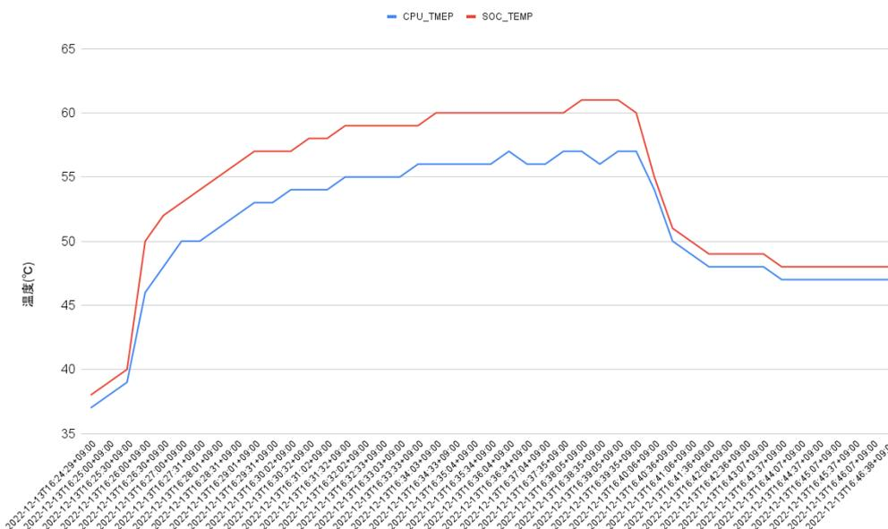
図 10.183 Armadillo-IoT ゲートウェイ G4 で取得した温度のグラフ
