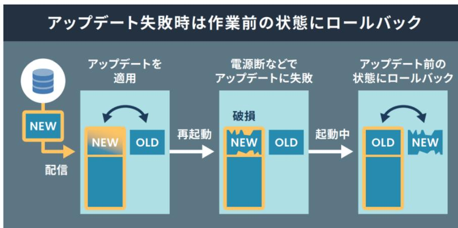
図 3.6 ロールバックの仕組み
