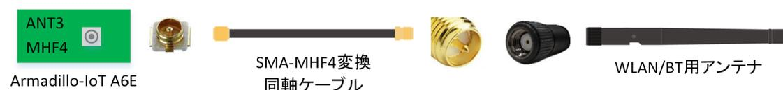
図 14.20 ANT3 RP-SMA 端子のアンテナ接続例
