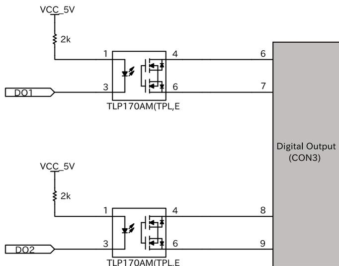
図 14.13 CON6 接点出力周辺回路
