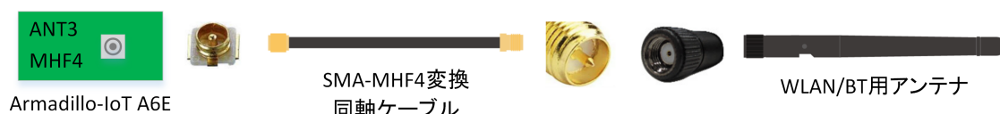
図 14.22 ANT3 RP-SMA 端子のアンテナ接続例
