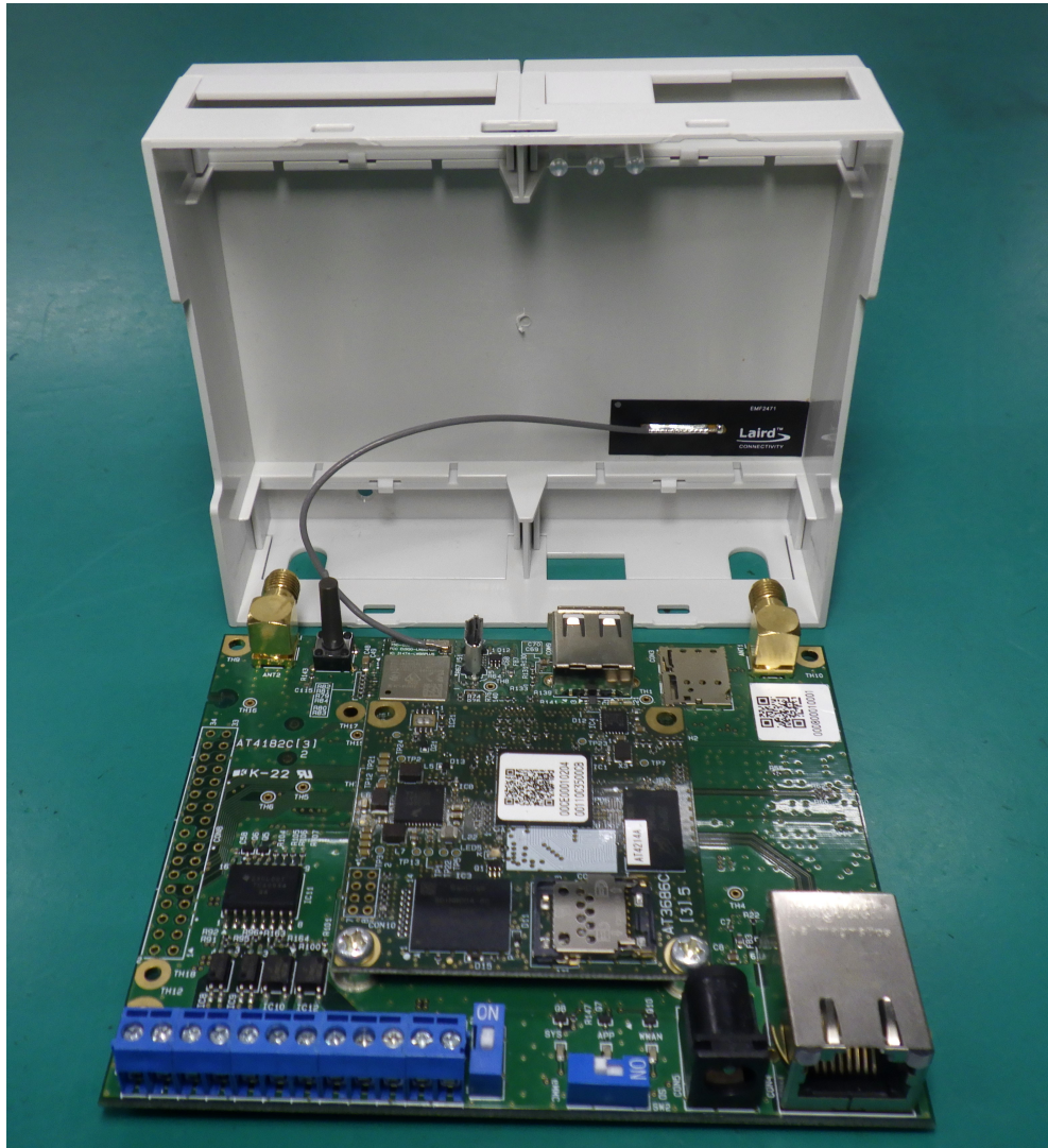
図 3.63 WLAN 基板アンテナの位置
