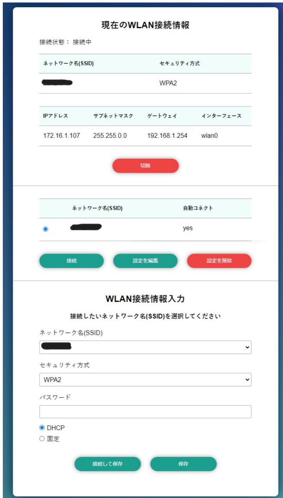
図 3.150 WLAN クライアント設定画面
