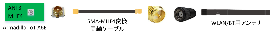
図 3.51 ANT3 RP-SMA 端子のアンテナ接続例
