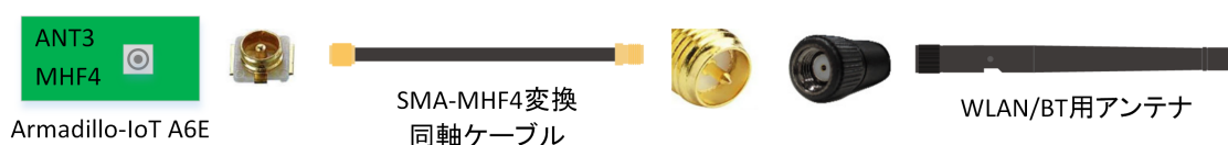
図 3.49 ANT3 RP-SMA 端子のアンテナ接続例
