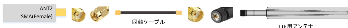
図 3.55 ANT2 50Ω 同軸ケーブルでの延長例(LTE アンテナインターフェース)
