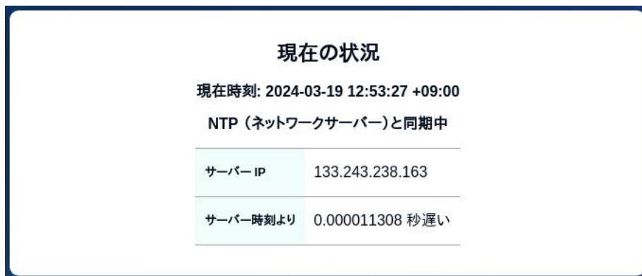
図 6.85 ネットワークタイムサーバーと同期されている場合の状況確認画面
