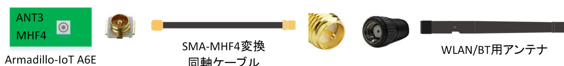
図 3.49 ANT3 RP-SMA 端子のアンテナ接続例
