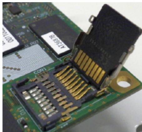
図 3.44 microSD カードの挿抜
