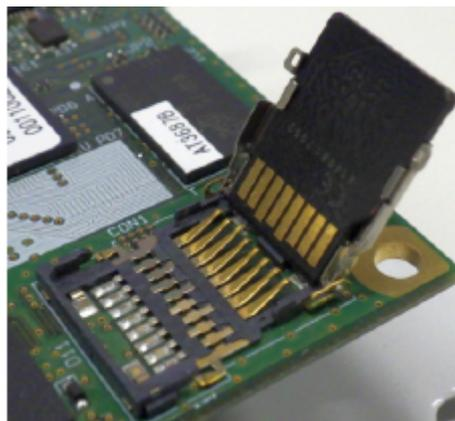
図 3.104 microSD カードの挿抜
