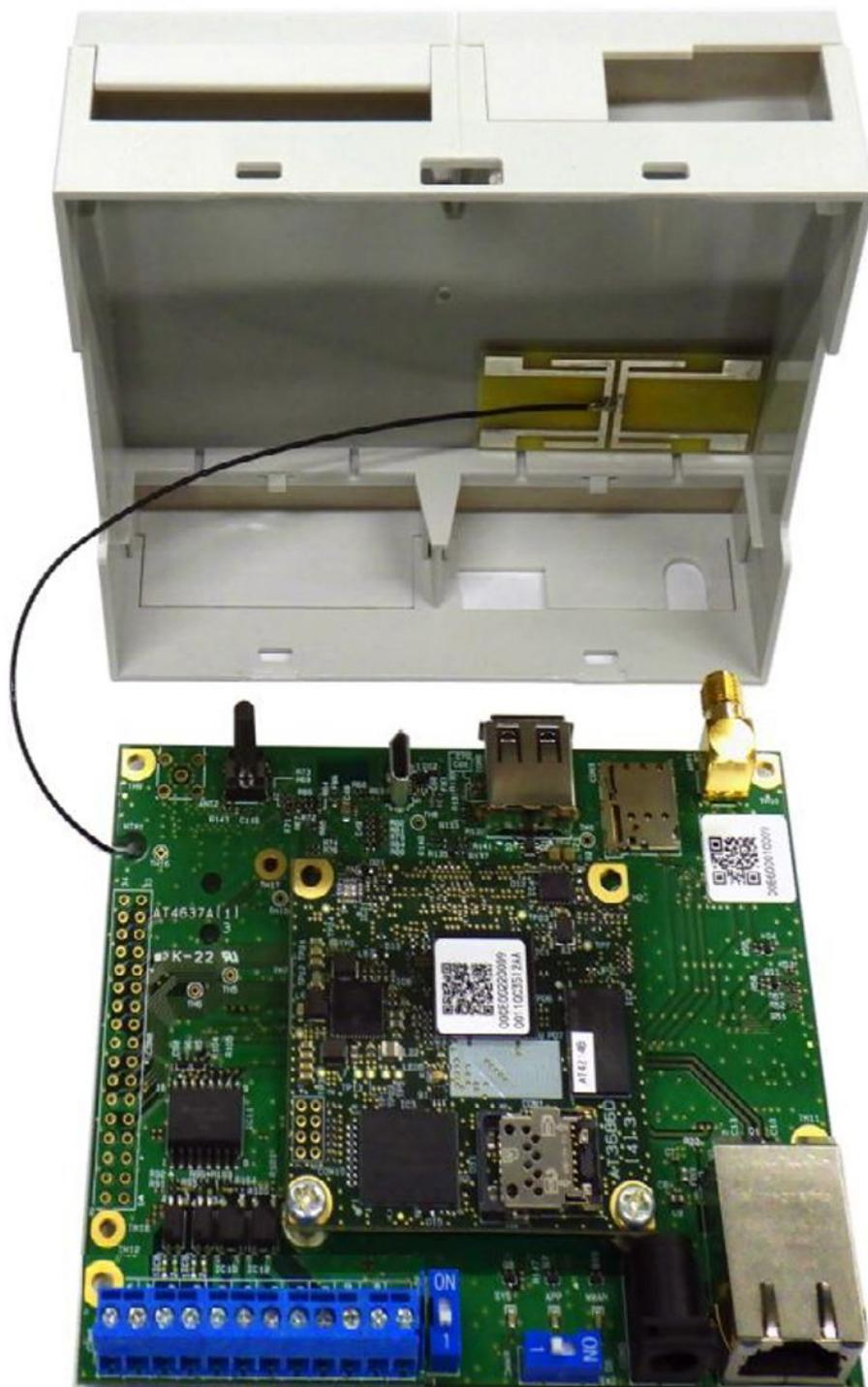
図 3.74 WLAN 基板アンテナの位置
