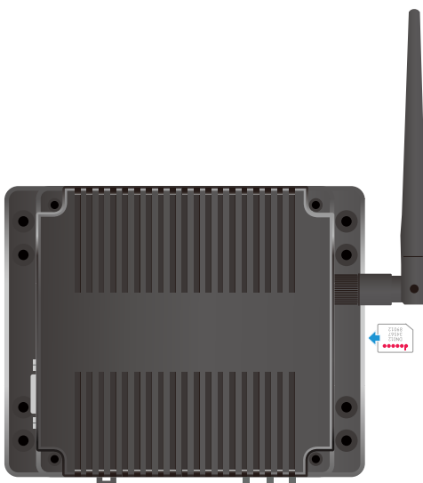
図 6.20 microSIM の取り付け
