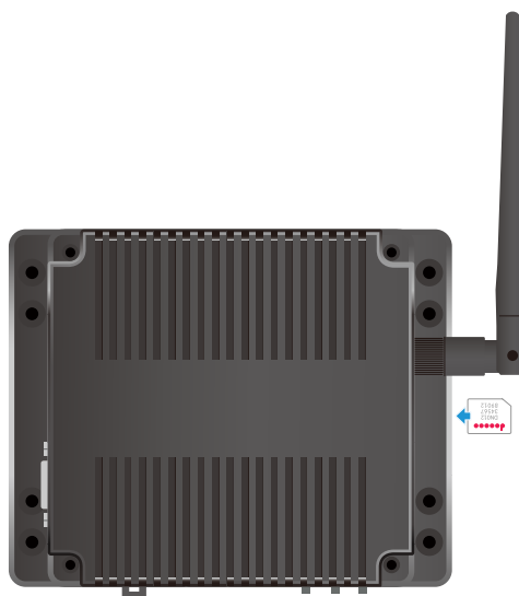
図 6.20 microSIM の取り付け
