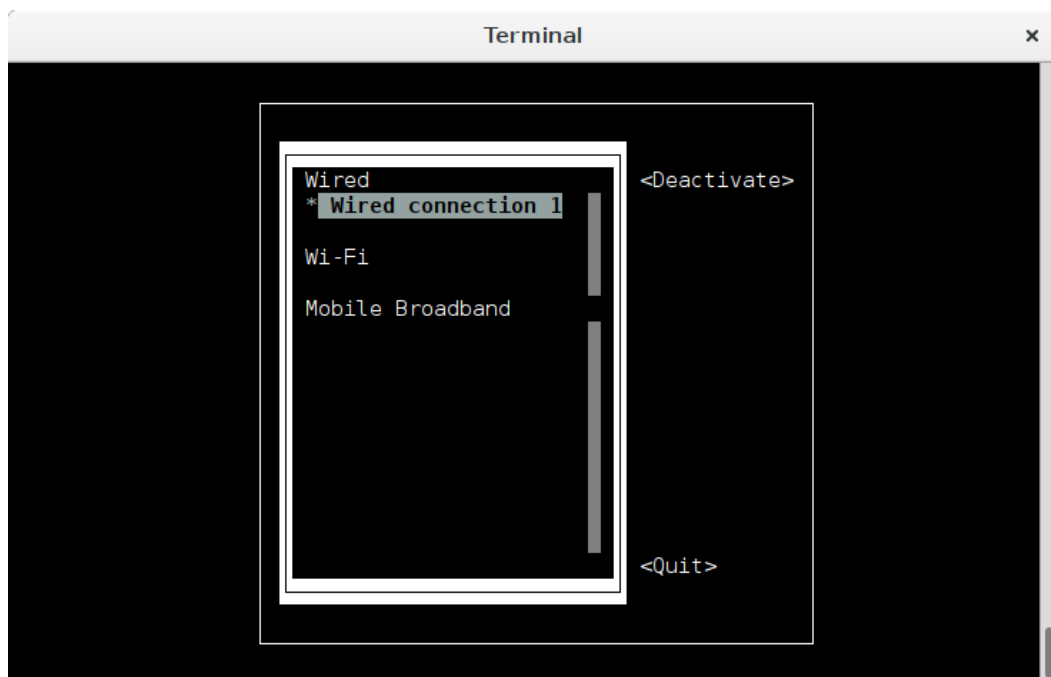
図 4.11 Connection を Activate する
