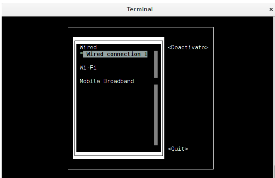
図 4.11 Connection を Activate する
